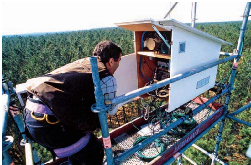
SITE DU BRAY. Tour de mesures dans une forêt de pins maritimes, vers Bordeaux, pour l'étude des mécanismes physiques régissant les transferts entre le couvert végétal et l'atmosphère.
