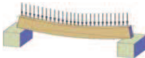
Fermeture des traits de scie (fibres comprimées)
