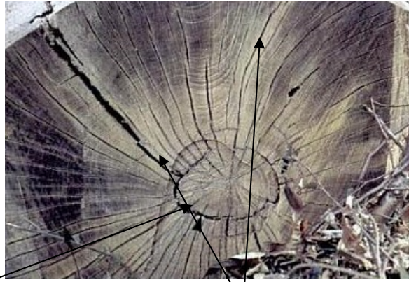
Roulure au centre de la bille de chêne, quadratures rayonnant vers sa périphérie
