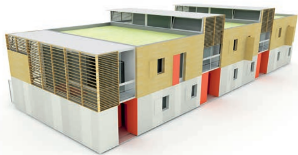
▲ Le bois est employé aussi bien en structure qu'en ossature ou encore en bardage, planchers intermédiaires y compris.
